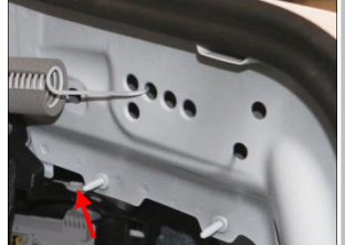
2.3 安装下支架右: 用箭头位置螺栓柱定位安装下支架右,用六角法兰面螺母 M6、弹簧垫圈安装
