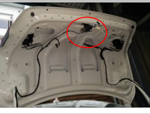
3.12 接尾门信号：在尾门上门锁扣位置找到原车信号；
