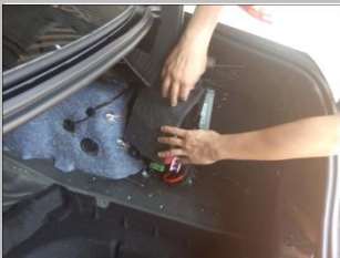
3.4 拆开尾箱右侧装饰板，在内侧接正极，CAN 信号，(CAN-L/CAN-H 信号)，负极均在右侧内部完成接线
