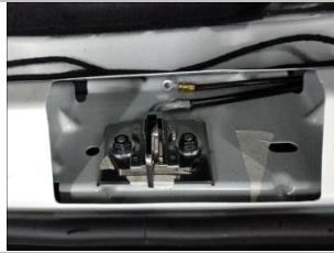
1.5 安装锁扣组,用两颗大垫圈 D6、六角法兰面螺母 M6 平行拧紧,安装时根据开关门的缝隙上下移动锁扣调整至合适位置;
