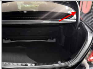
3.2 拆卸塑料扣，原车摇臂上的塑料件拆下，把 2 扎布线束（接开关、接门锁信号）从尾箱左侧沿着摇臂延伸到上门锁
