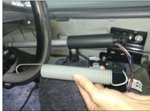
2.11 弹簧装回去的时候，要反个方向装，如图示意正确安装
