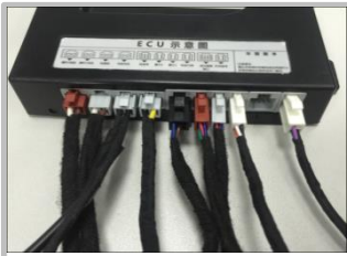
4.1 连接 ECU，待所有线束插好，最后插电源线插头
