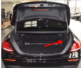
2.1 把右边内侧装饰件拆下,并妥善保管好,后续还原安装;(箭头)
