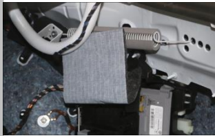
2.2 拆原车气弹簧 把原车右边气弹簧拆卸; 注意防止尾门掉下;
