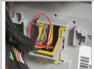
3.10 CAN 信号：把信号线引到尾箱右侧位置此黄色原车连接器，用于连接原车信号线；
