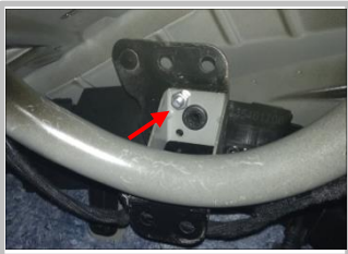
2.7 安装上支架右：装上支架时，先用内六角平圆头螺钉 M6 16 螺钉把上支架固定，再装夹紧支架
