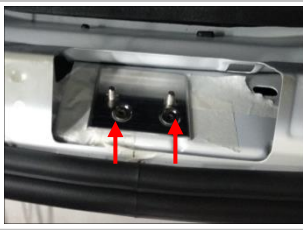
1.4 安装门锁垫板组,用两颗内六角沉头螺钉 M6_20 平行拧紧
