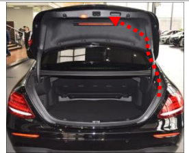
3.3 把 2 扎布线束（接开关、接门锁信号）延伸到尾箱上门锁扣处，延伸线用胶布或扎带固定好；（虚线）
