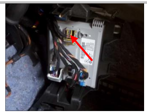
3.9 CAN 信号：在此连接器模块上找到原车线束
