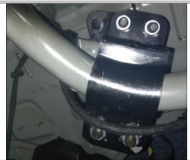
2.9 如图示意，右上支架已安装好，对称安装另一边支架
